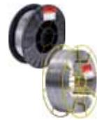
Используется для полуавтоматической сварки углеродистых и низкоуглеродистых марок сталей. Медное покрытие значительно увеличивает проводимость тока за счет уменьшения контактного сопротивления. Это дает возможность поддерживать равномерную дугу сварки и повышать качество сварного шва за счет отсутствия окисления.
